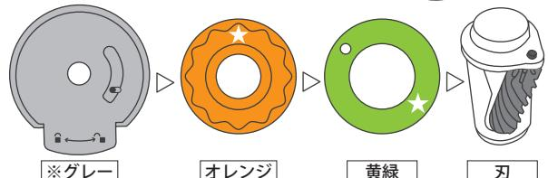
④刃部分のパーツを真上に引っ張りながら取り外します。刃に触れないよう注意し短い鉛筆や折れた芯を取り除いてください。
