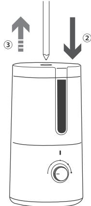
③削り終わると自動で鉛筆が浮き上がり、自動で静止します。鉛筆をゆっくり抜いて完成です。
